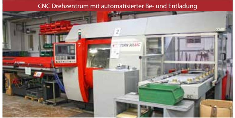
CNC Drehzentrum mit automatisierter Be- und Entladung
