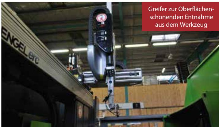
Greifer zur oberflächenschonenden Entnahme aus dem Werkzeug
