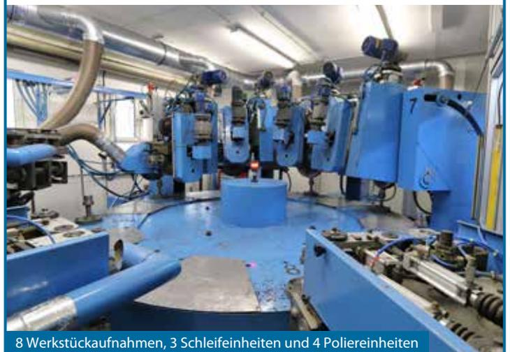
8 Werkstückaufnahmen, 3 Schleifeinheiten und 4 Poliereinheiten
