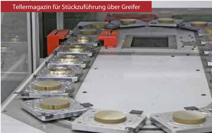
Tellermagazin für Stückzuführung über Greifer
