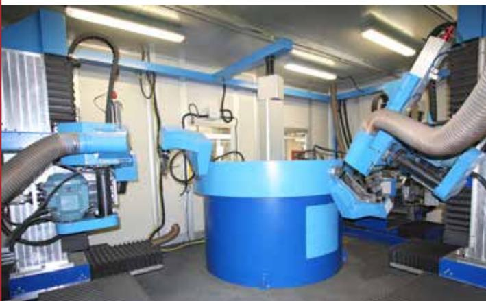
4 Werkstückaufnahmen mit je 2 Achsen, 1 Schleifeinheit mit 2 Schleifstationen, 2 Doppelpolierereinheiten mit je 2 Polierstationen. Alle Stationen 5-achsig
